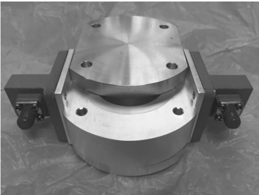
图1 上盖板可拆卸的圆柱谐振腔实物图
